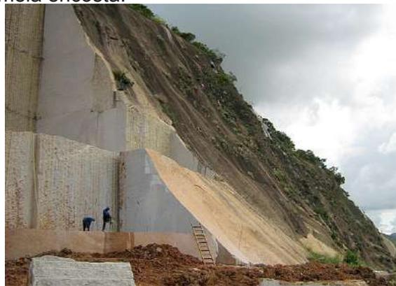
Figura 46 – Flanco íngreme de um morro, porém estável e sem cobertura de solo. Fonte: Ferma.
