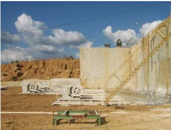
Figura 38 – Máquinas de fio diamantado com uso frequente nas operações de lavra. Fonte: Ferma
