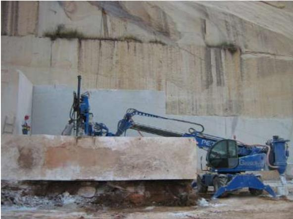
Figura 37 – Perfuratriz montada em trator com braço escamoteável. Fonte: Ferma.
