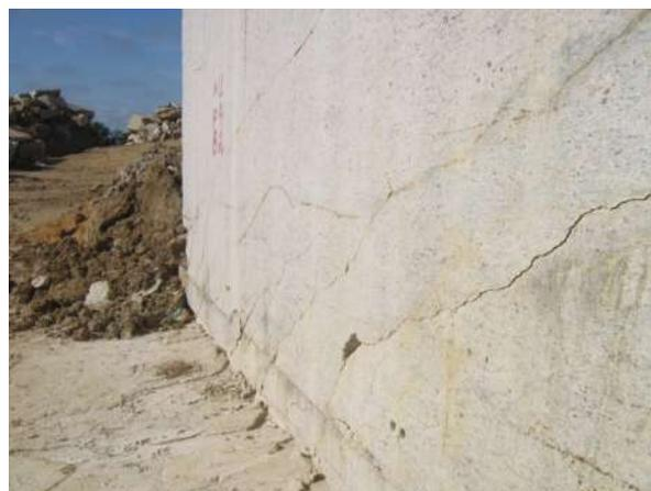
Figura 64 – Trincas em excesso inviabilizam a extração. Fonte: Ferma.
