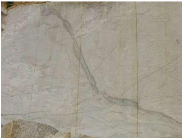
Figura 66 – Veios e fraturas dificultam a extração e diminuem o valor comercial da rocha. Fonte: Ferma
